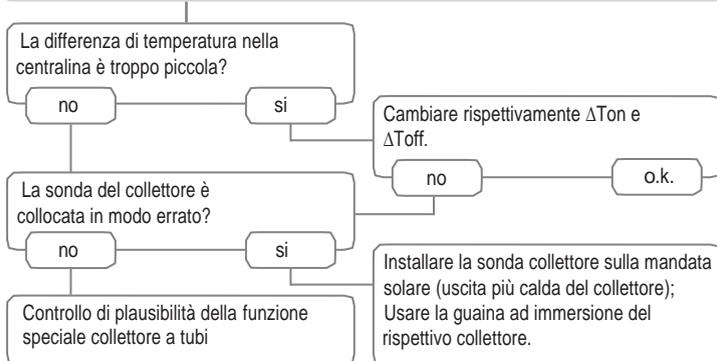
La differenza di temperatura tra serbatoio e collettore cresce molto durante il funzionamento; il circuito del collettore non è in grado di asportare il calore.
